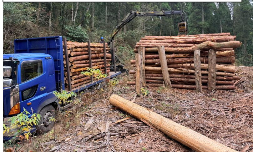
①山土場から中間土場へ運搬する原木を小型トラックに積み込む
