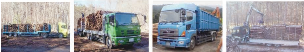
写真 2.7.6 各種大型トラックによる輸送 (左から順に、セミトレーラー・フルトレーラー・大型深ダンプトラック・ヒアブ付トラック)
