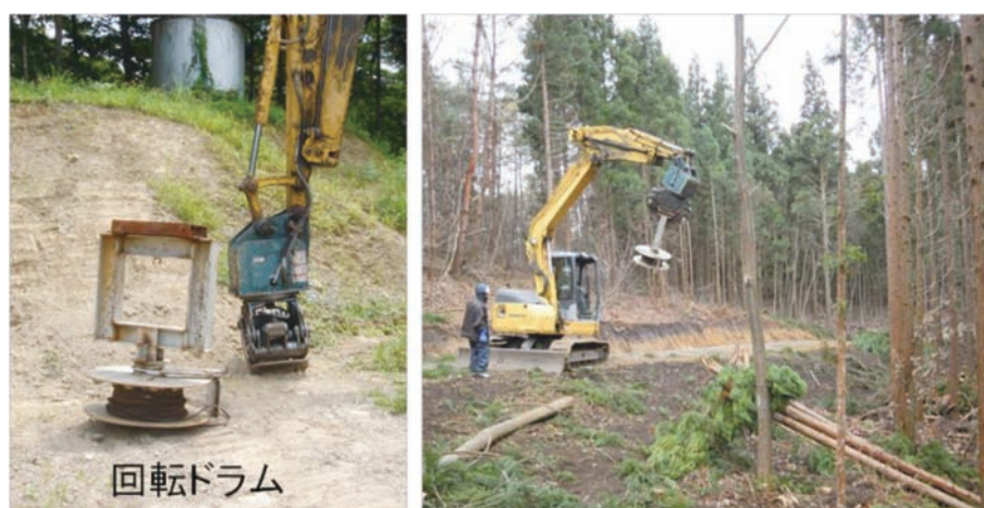
写真 2.5.2 回転ドラムを用いた木寄せ作業
